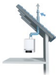
Nasávání spalovacího vzduchu z venkovního prostoru.
