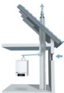
Nasávání spalovacího vzduchu z místnosti instalace.
