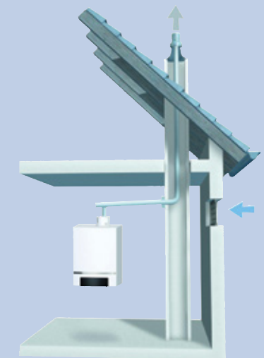
Spotřebič typu B - nasávání spalovacího vzduchu z místnosti instalace
