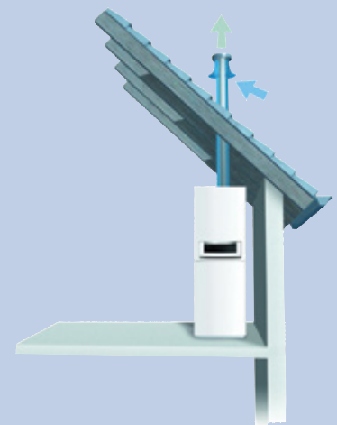
Spotřebič typu C - nasávání spalovacího vzduchu z venkovního prostoru
